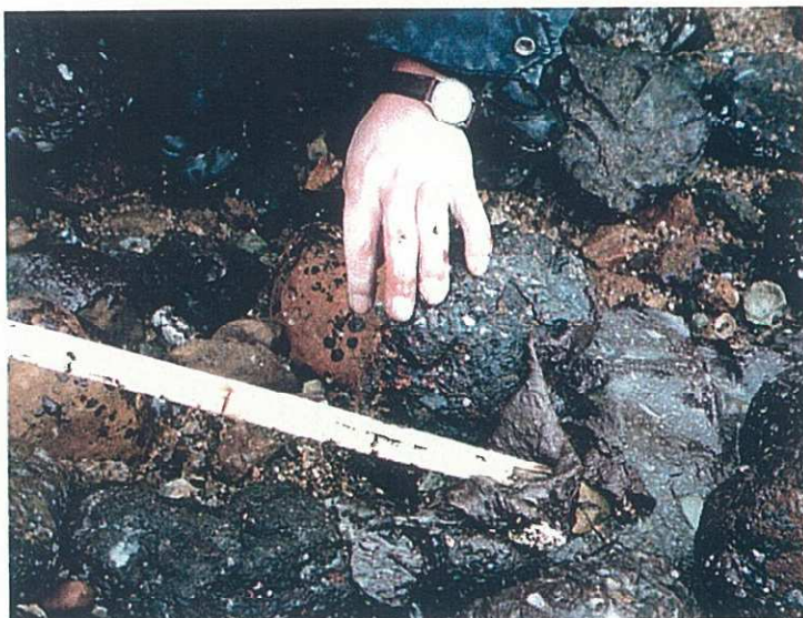
(b) 漂着油をテラザイムで処理した後は、棒を使って石から剥がれるようになった。
